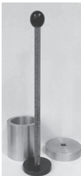
**Figura 3.** Elementos del sistema de compactación
