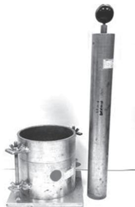
**Figura 1.** Elementos del sistema de compactación Proctor
