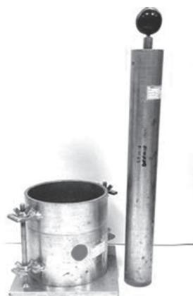
**Figura 1.** Elementos del sistema de compactación Proctor
