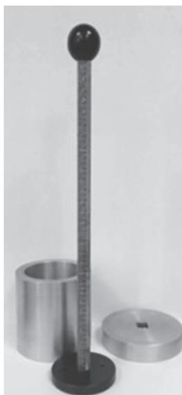
**Figura 3.** Elementos del sistema de compactación
