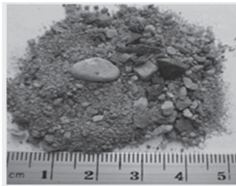
**Figura 4.** Fotografías de agregado fino (arenas) cantera Cancun.
